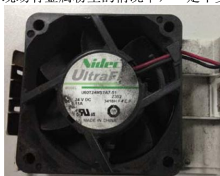
风扇上布满金属粉尘
